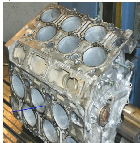
е) W-двигатель с компоновкой – две VR-компоновки с малым углом развала
