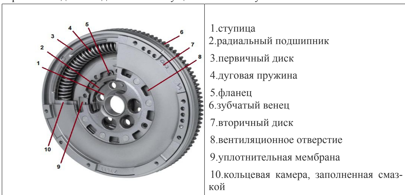
Рисунок 2.9 – Маховик двухмассовый
