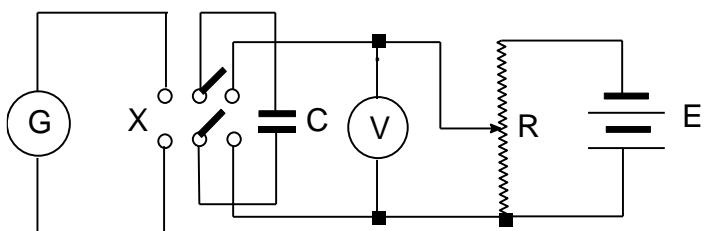
$E$  — источник напряжения (аккумулятор);
