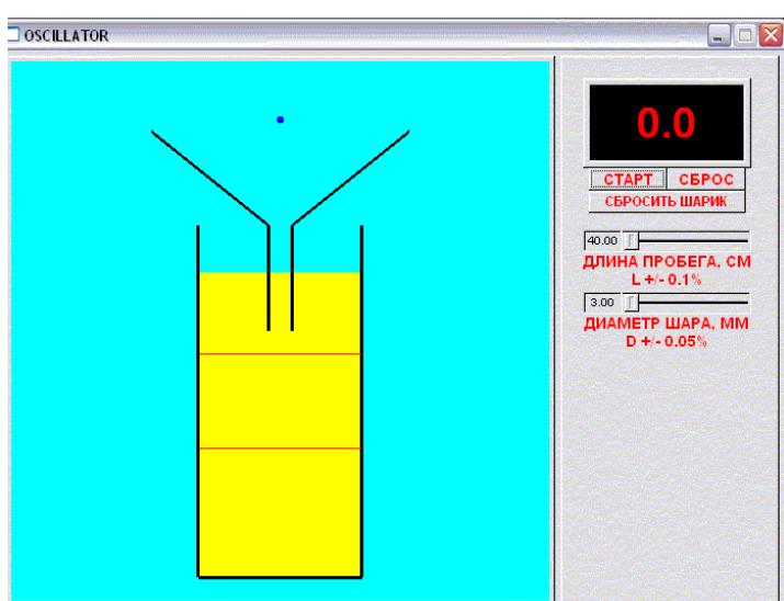
Для опыта используется виртуальная лабораторная установка, включающая в себя стеклянный цилиндр, в который налита исследуемая жидкость (глицерин).
