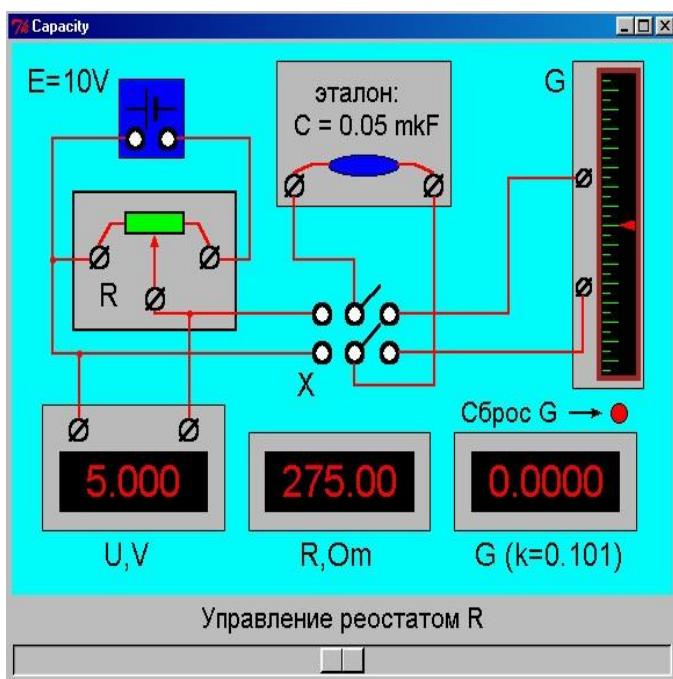
1. Цепь питания мостовой схемы с ЭДС = 10 В и ключом  $X$ . Напряжение заряда конденсаторов Урегулируется переменным резистором  $R$ . Контроль за показаниями осуществляется цифровыми индикаторами величин напряжения и сопротивления.
