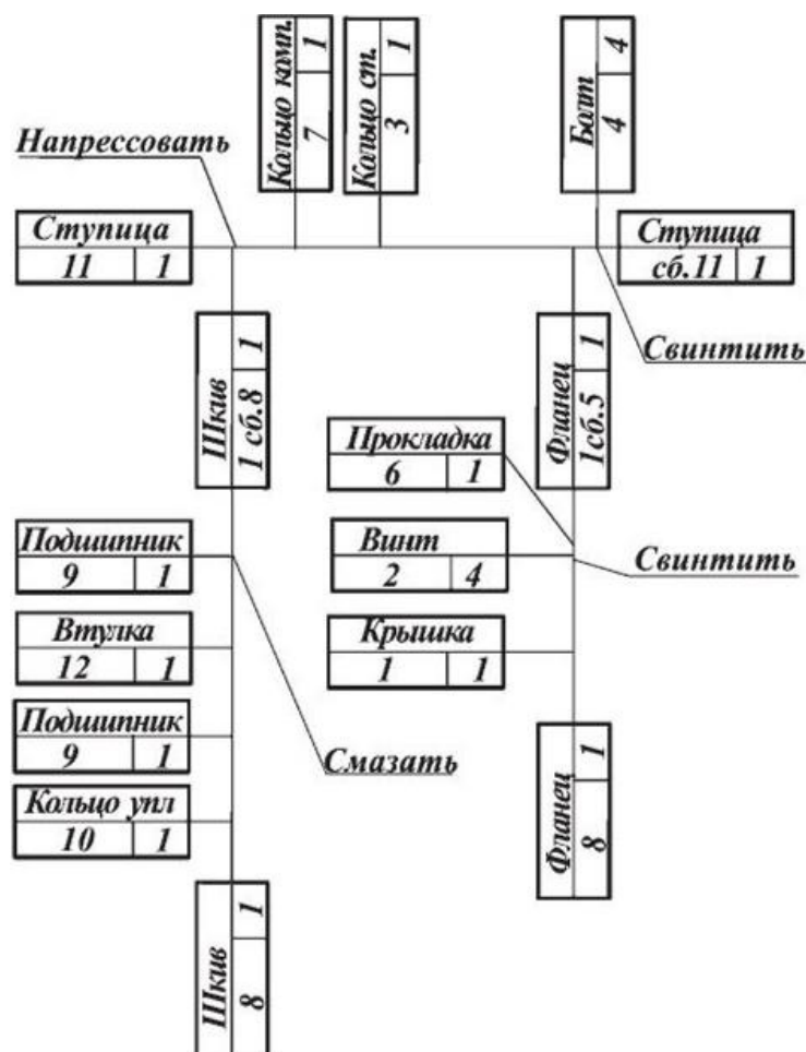
Рисунок 7.4 – Технологическая схема сборки ступицы
