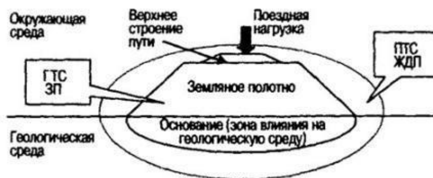
Рисунок 8 – Схема геотехнической системы «Земляное полотно» железных дорог
