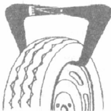
Рисунок 11 – Измерение ширины обода кронциркулем
