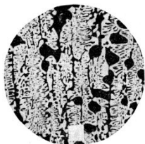
Рисунок 6 – Микроструктура заэвтектического белого чугуна – 5%С, ( \times 200 )
