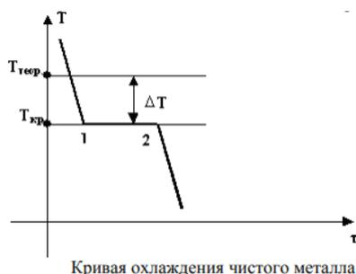
точки 1 металл находится в жидком состоянии, температура системы уменьшается плавно. При достижении температуры кристаллизации на кривой охлаждения появляется горизонтальная площадка (1-2), так как отвод теплоты в окружающую среду компенсируется выделяющейся при кристаллизации скрытой теплотой кристаллизации. По окончании кристаллизации (точка 2) температура вновь уменьшается плавно.
