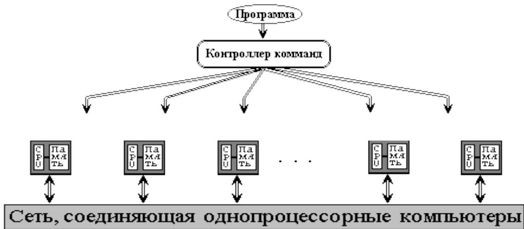
Другим свойством, различающим параллельные компьютеры, является способ доступа к модулям памяти, то есть имеет ли каждый процессор локальную память и обращается к другим блокам памяти, используя коммутирующую сеть, или коммутирующая сеть соединяет все процессоры с общей памятью. Исходя из способа доступа к памяти, различают следующие (довольно условные) типы параллельных (MIMD) архитектур:
