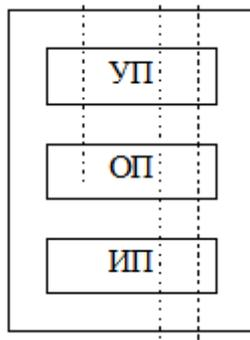
Пример: если невозможно реализовать ОП 16-ти разрядов в одной БИС, его делят на части, реализуемые каждая в своей БИС. Они образуют микропроцессорные секции (например, 4-разрядная микропроцессорная секция).
