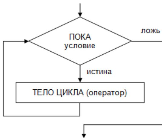
Блок-схема цикла с предусловием.
