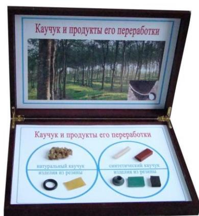
Рисунок 1 – Образцы каучуков и продуктов его переработки
