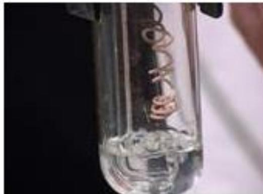
Рисунок 1 – Окисление этилового спирта оксидом меди (II)
