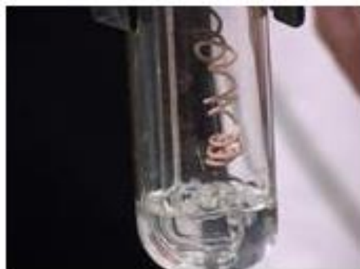
Рисунок 1 – Окисление этилового спирта оксидом меди (II)
