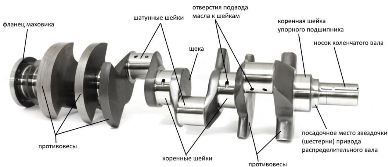
Рисунок 2.3 – Коленчатый вал 4-х цилиндрического двигателя
