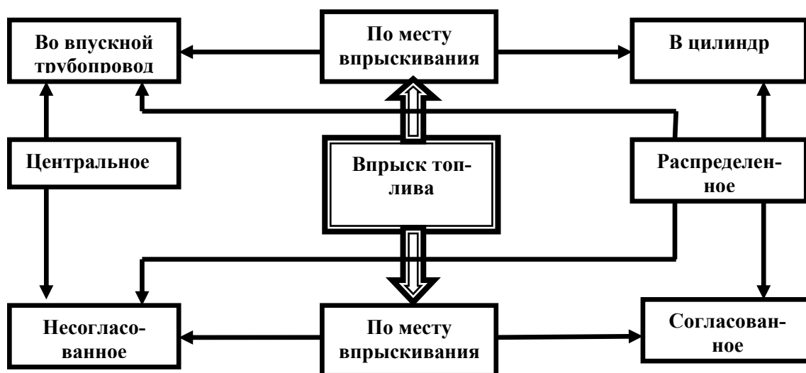
Рисунок 8.1 – Классификация способов впрыскивания топлива
