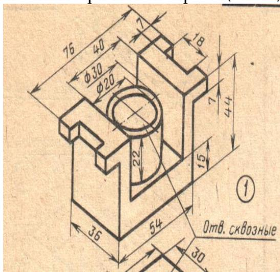
чертеж. Выполнить разрезы, поясняющие формы внутренних поверхностей модели. Нанести размеры. (ПК1.2; ПК 1.3; ПК 2.3)
