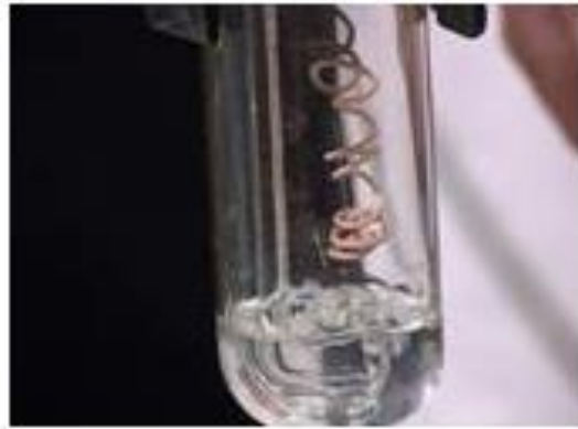
Рисунок 1 – Окисление этилового спирта оксидом меди (II)
