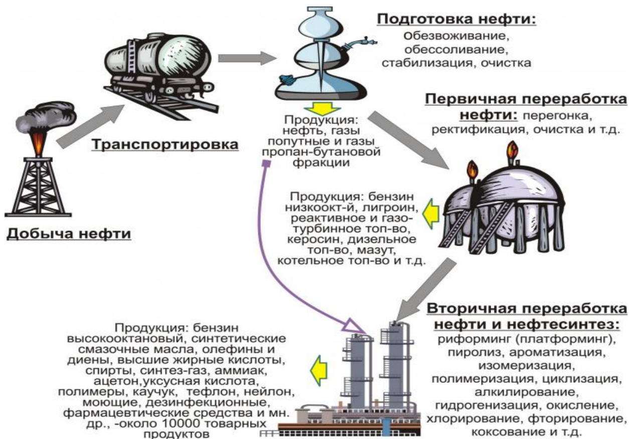
Рисунок 1.1 – Схема получения нефтепродуктов из нефти
