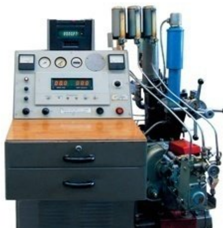
Рисунок 2.10 – Установка ИДТ-90 для определения цетанового числа дизельных топлив
