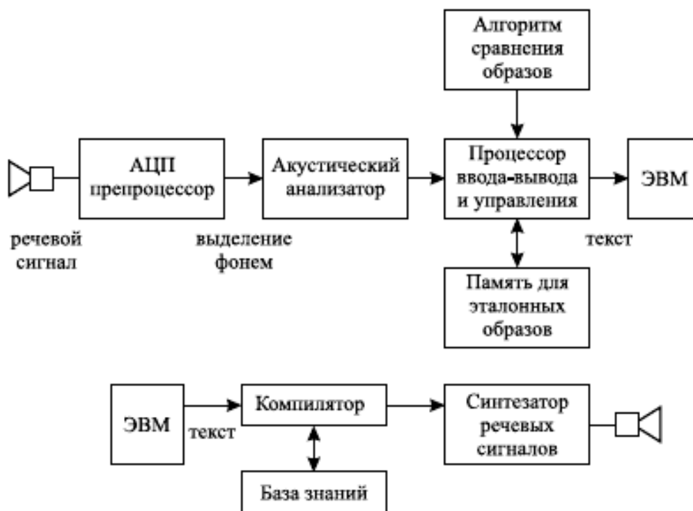
Рисунок 5.3 - Анализатор и синтезатор речевых сообщений в потоке информации
