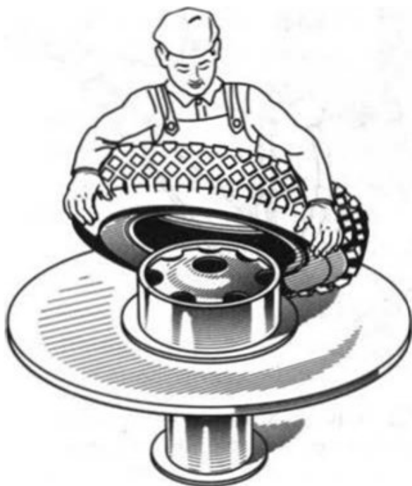
Рисунок 3.5 – Монтажно-демонтажный вращающийся стол (высота над уровнем пола 500 мм)
