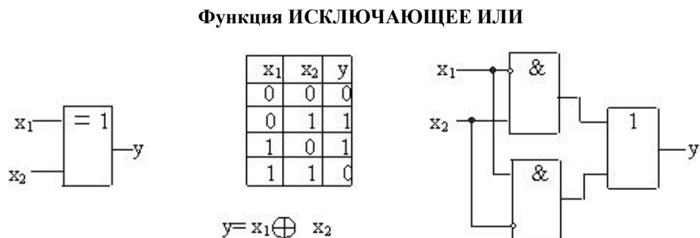
Рис. 11.13. УГО, таблица истинности и структурная схема ЛЭ ИСКЛЮЧАЮЩЕЕ ИЛИ
