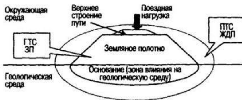
Рисунок 8 – Схема геотехнической системы «Земляное полотно» железных дорог
