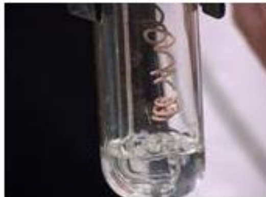
Рисунок 1 – Окисление этилового спирта оксидом меди (II)
