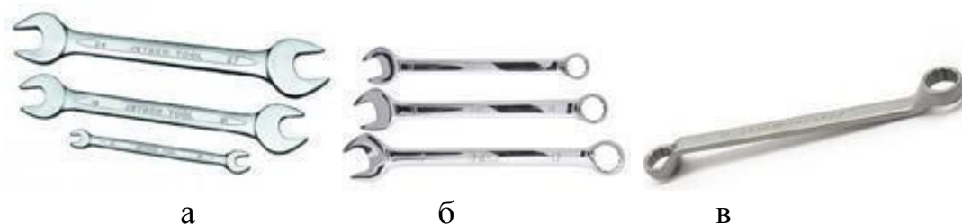
а – рожковые; б – комбинированные; в – накидной
