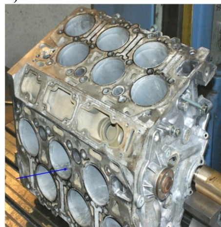
е) W-двигатель с компоновкой – две VR-компоновки с малым углом развала
