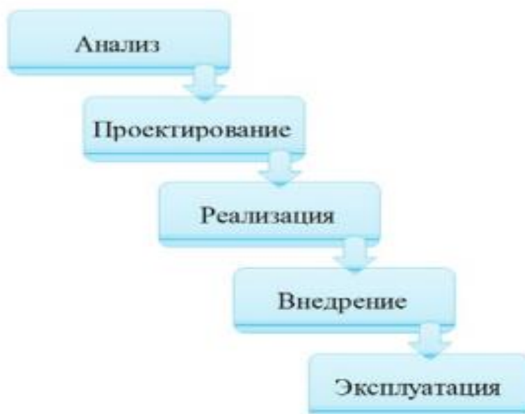
Рисунок 2 – Каскадная (водопадная, классическая) модель ЖЦ ИС
