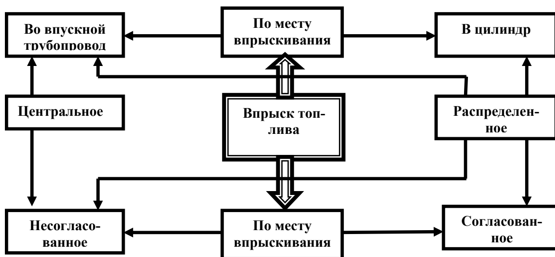
Рисунок 8.1 – Классификация способов впрыскивания топлива
