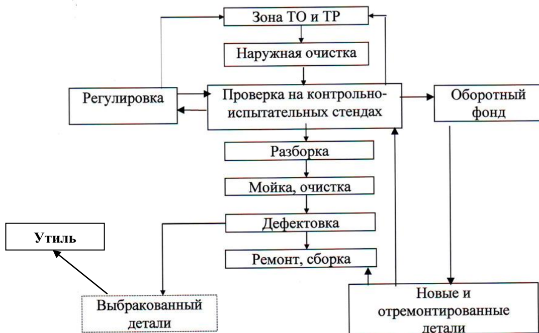
Схема технологического процесса цеха ремонта топливной аппаратуры
