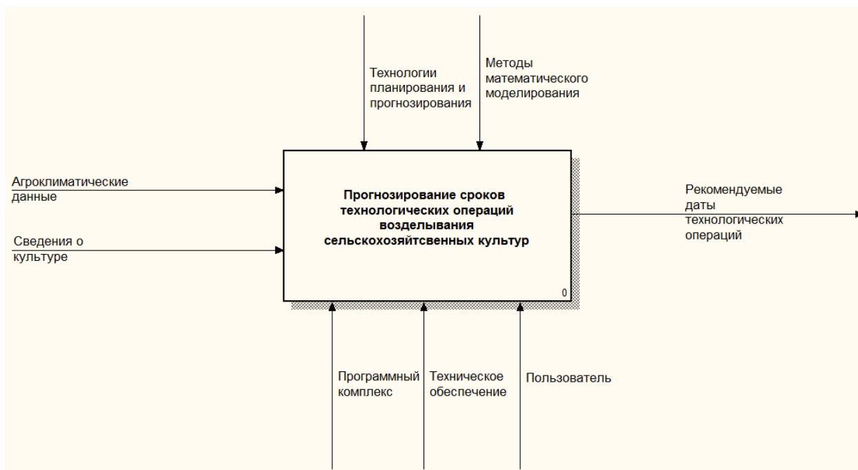
Рисунок 1.12 – Функциональная модель информационной системы
