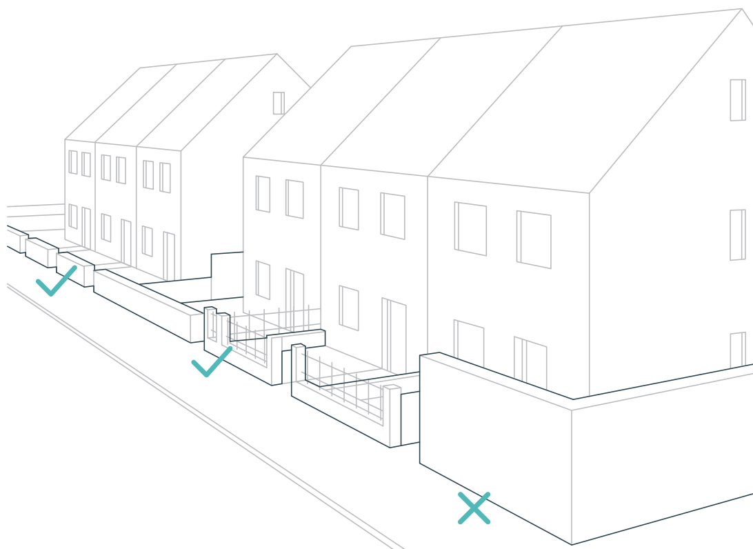
Илл 15. Пример организации заборов и ограждений на основе рекомендаций, установленных градостроительным регламентом города Плимут
