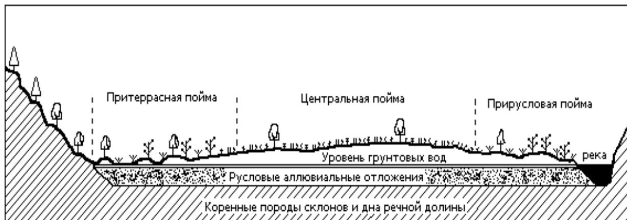
Рис. 3. Схема профиля рельефа поймы (по В.Вильямсу)
