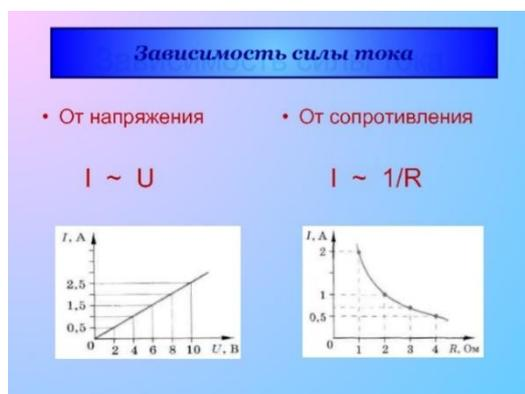
График зависимости силы тока от напряжения называется вольт-амперной характеристикой.
