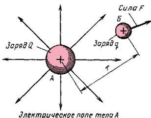
Рис. 4. Действие электрического поля на внесенный в него электрический заряд q.
