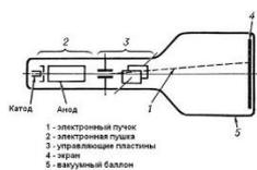
Такая конструкция позволяет получить узкий электронный пучок, который на пути к экрану проходит последовательно между двумя парами пластин, расположенных вертикально и горизонтально. При подаче напряжения на пластины пучок отклоняется в электрическом поле, что позволяет перемещать светящуюся точку по экрану в любом направлении.
