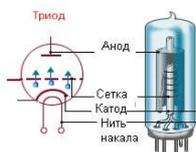
**триод** (трехэлектродная электронная лампа) имеет дополни-
