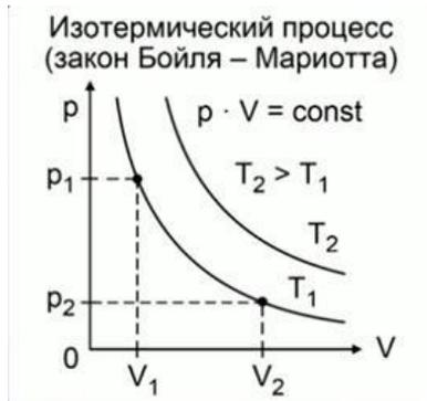
Графики изотермических процессов в координатах P-V
