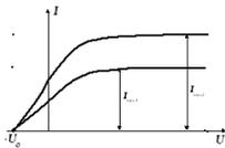
Рис. 2. Вольтамперная характеристика вакуумного фотоэлемента для разных освещенностей фотокатода.
