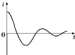
Всякий реальный колебательный контур имеет сопротивление проводов  $R$ . Если ему один раз сообщить энергию, например, зарядив конденсатор  $C$ , то колебания в нем будут затухающими из-за потерь энергии на джоулево тепло. График затухающих колебаний силы тока изображен на рисунке.
