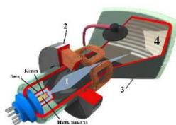
**Электронно-лучевая трубка (ЭЛТ)** является основным элементом осциллографа — прибора для исследования быстропеременных процессов в электрических цепях. Трубка представляет собой вакуумный баллон, одна из стенок которого является экраном. В узкой части трубки находится электронная пушка, состоящая из нити накала, катода и анода в виде цилиндра с отверстием.
