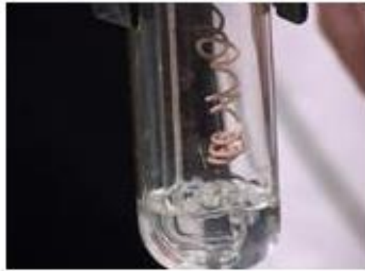
Рисунок 1 – Окисление этилового спирта оксидом меди (II)
