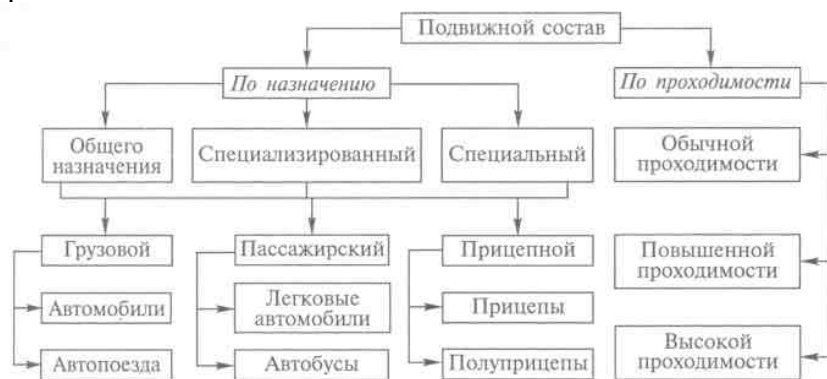
Рис. 1.1. Классификация типов подвижного состава автомобильного транспорта по назначению и проходимости
