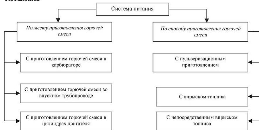
Рис. 7.2. Различные системы питания по способу приготовления горючей смеси
