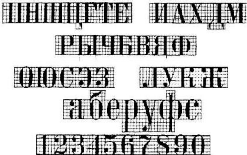
Рис. 13. Образец построения букв и цифр шрифта Обыкновенный
