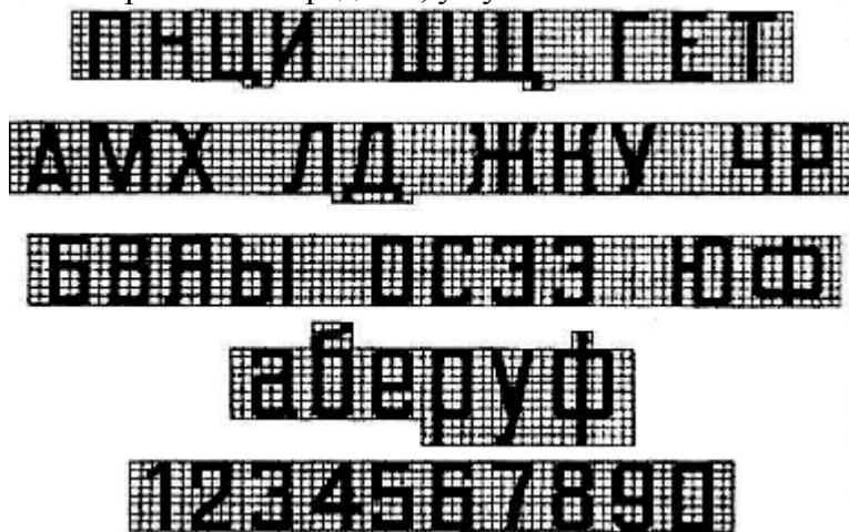
Рис. 8. Образец построения букв и цифр рубленого полужирного шрифта
