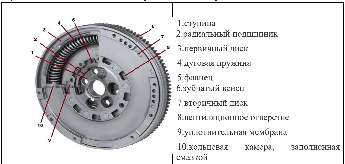
Рисунок 2.9 – Маховик двухмассовый
