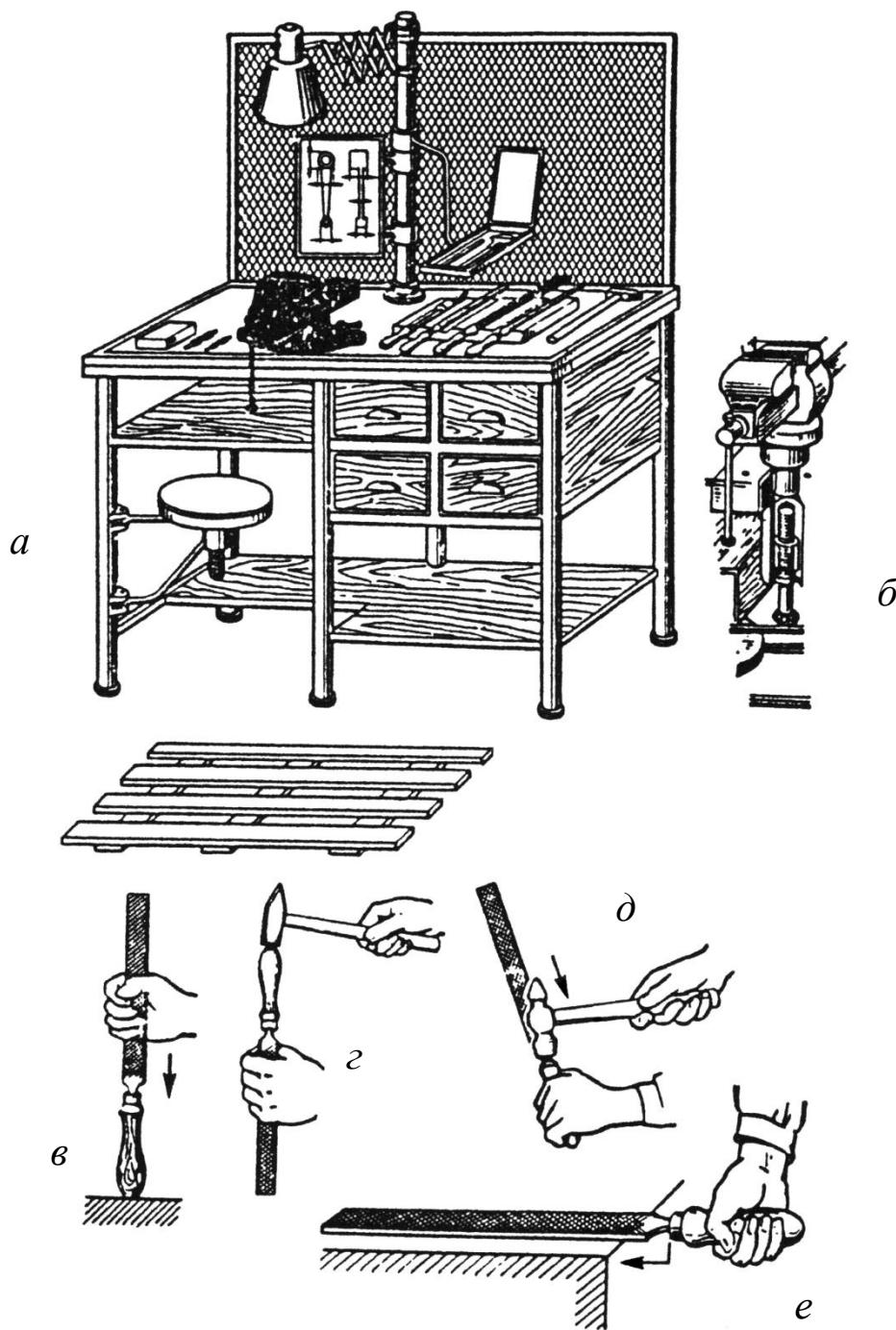
Рисунок 26 – Организация рабочего места слесаря при опиливании:
