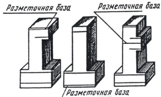
Рисунок 6 – Подготовка заготовки к разметке:
