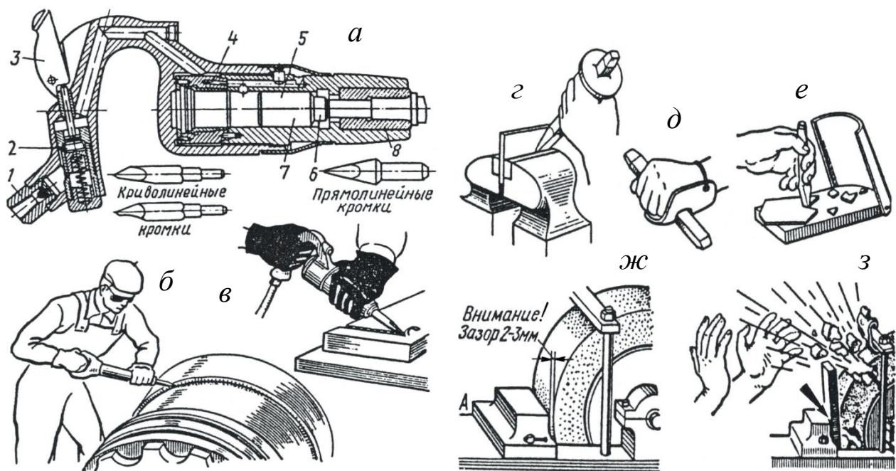
1 – штуцер; 2 – клапан; 3 – курок; 4 – золотник; 5 – камера рабочего хода; 6 – камера обратного хода; 7 – ударник; 8 – ствол
