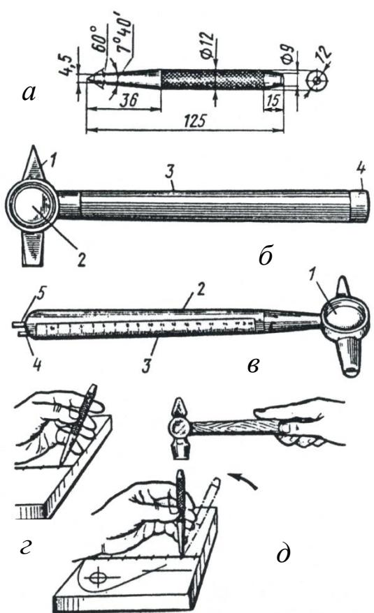
Рисунок 4 – Кернение разметочных рисок:
