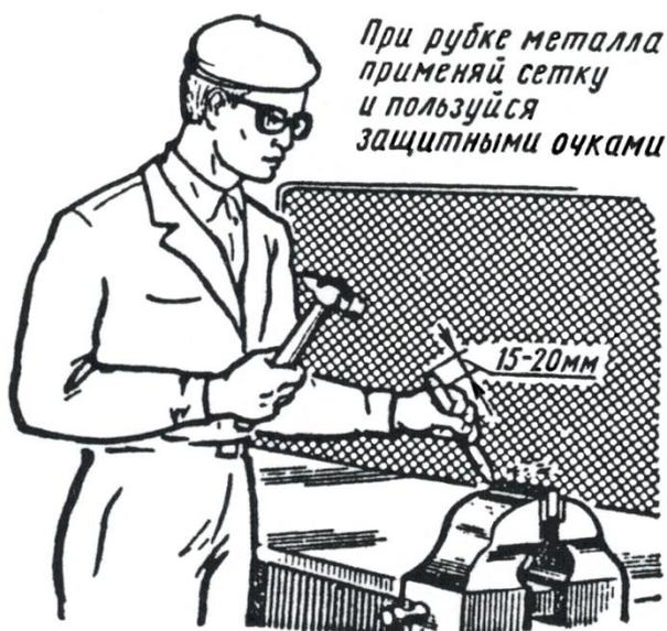
Рисунок 8 – Рубка в слесарных параллельных тисках
