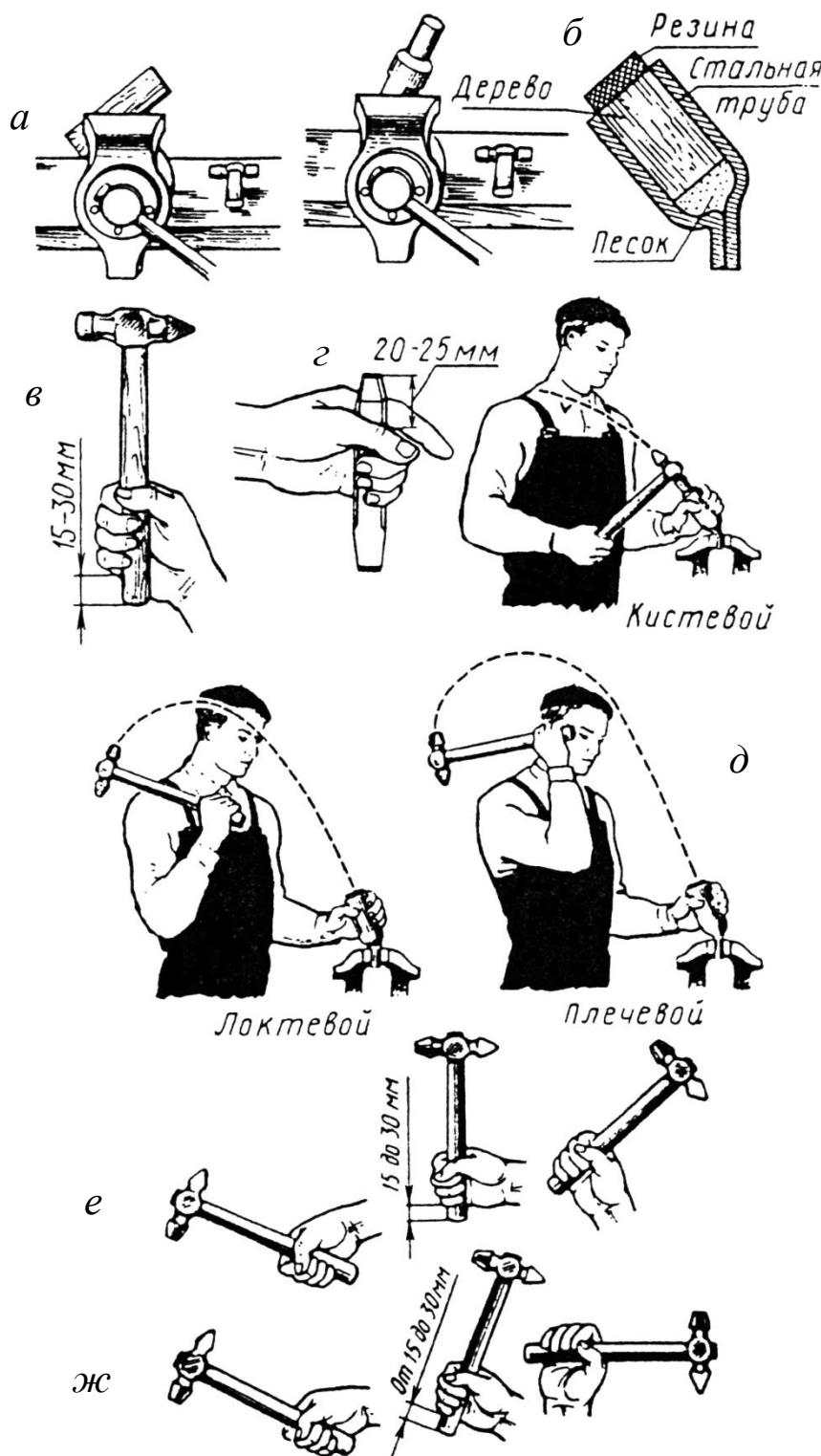
Рисунок 10 – Приёмы рубки металла:
