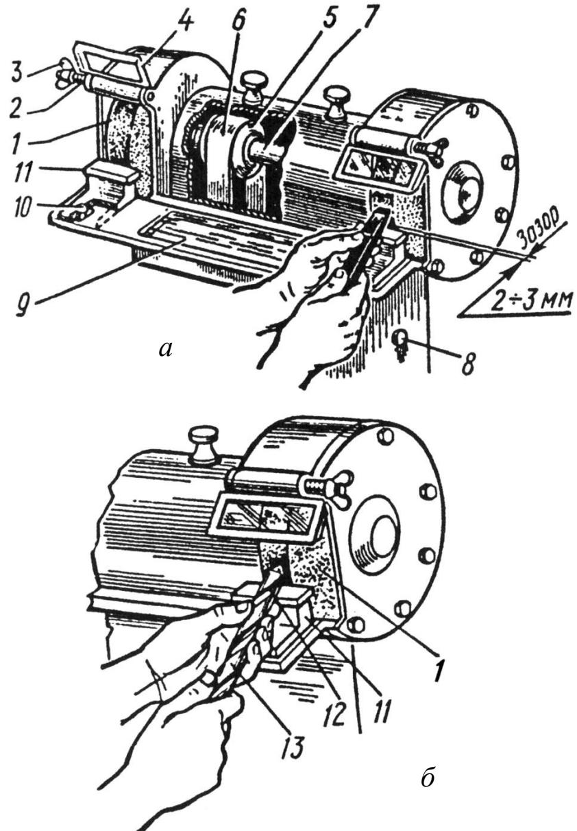
1 – круг; 2 – пружина; 3 – гайка-барашек; 4 – экран; 5 – шкив;
