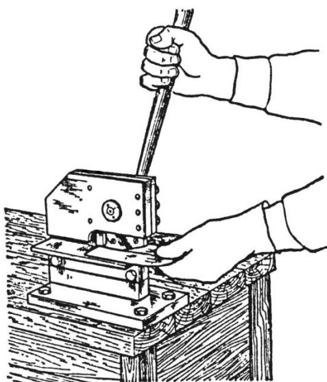
Рисунок 23 – Резка ручными ножницами по металлу
