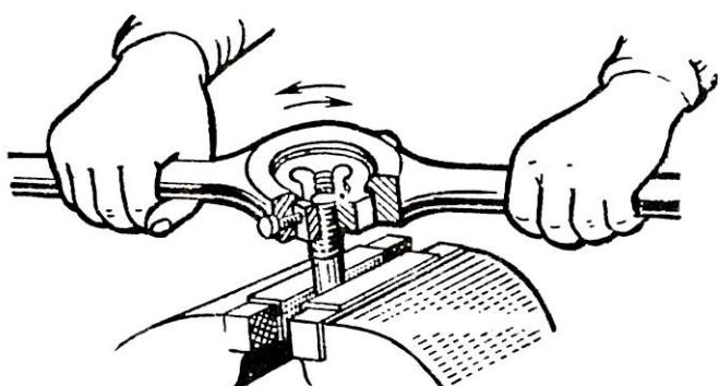
Рисунок 36 – Приёмы нарезания резьбы плашками
