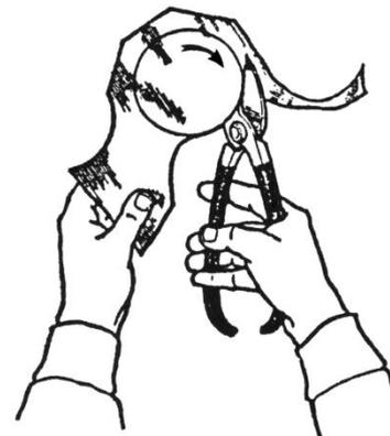
Рисунок 24 – Резка листового металла на рычажных ножницах
