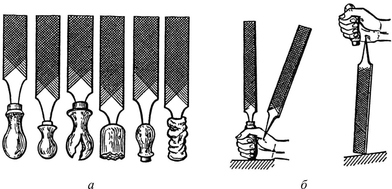
Рисунок 25 – Образцы негодных ручек и неправильной насадки:
