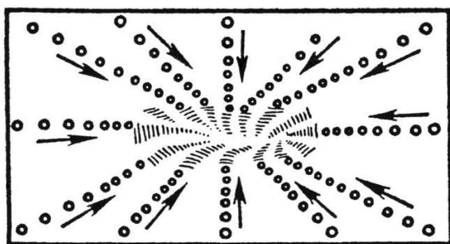
Рисунок 14 – Схема правки листового материала на плите
