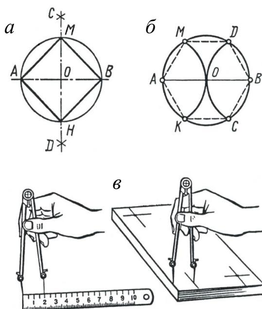
Рисунок 2 – Разметка кривых линий:
