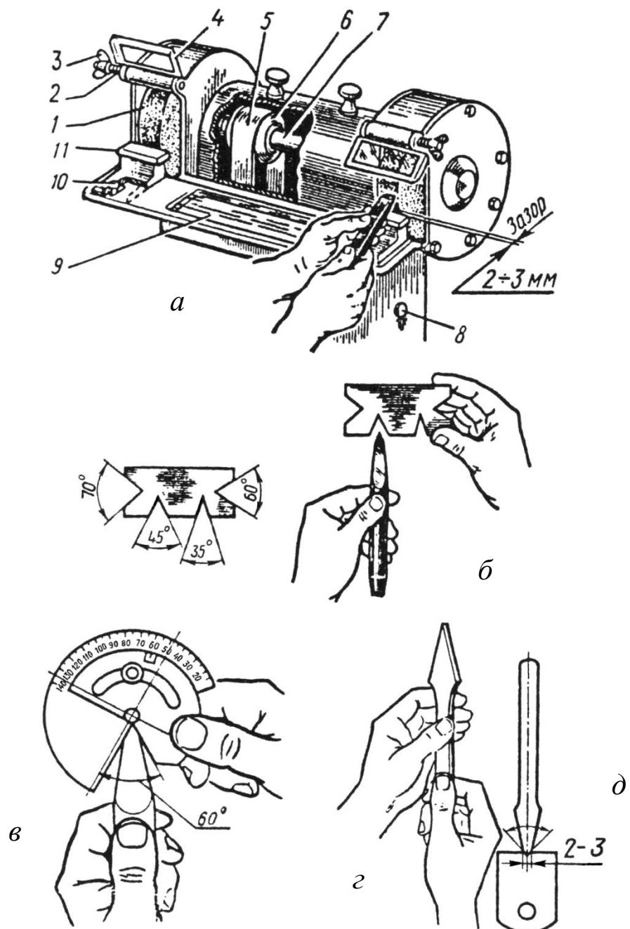
1 – круг; 2 – пружина; 3 – гайка-барашек; 4 – экран; 5 – шкив;
