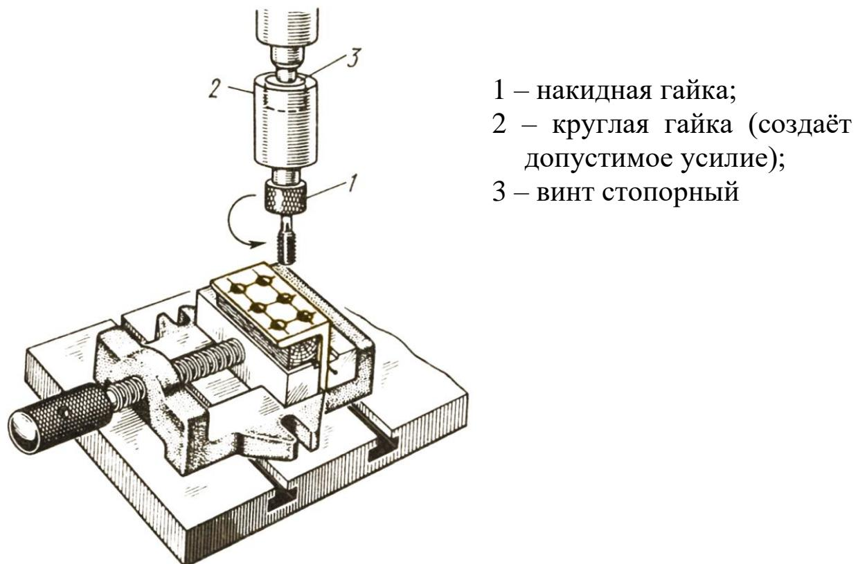
Рисунок 37 – Нарезание резьбы метчиком в отверстии на сверлильном станке
