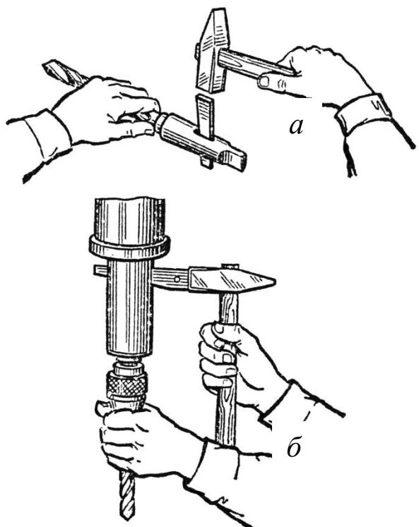
Рисунок 31 – Удаление инструмента:
