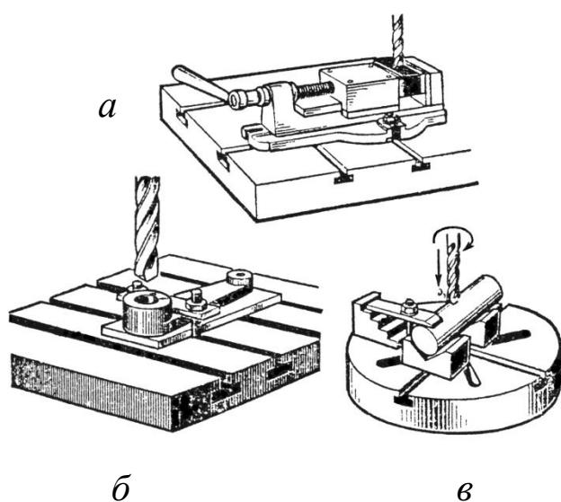
Рисунок 32 – Сверление деталей с закреплением на столе станка:
