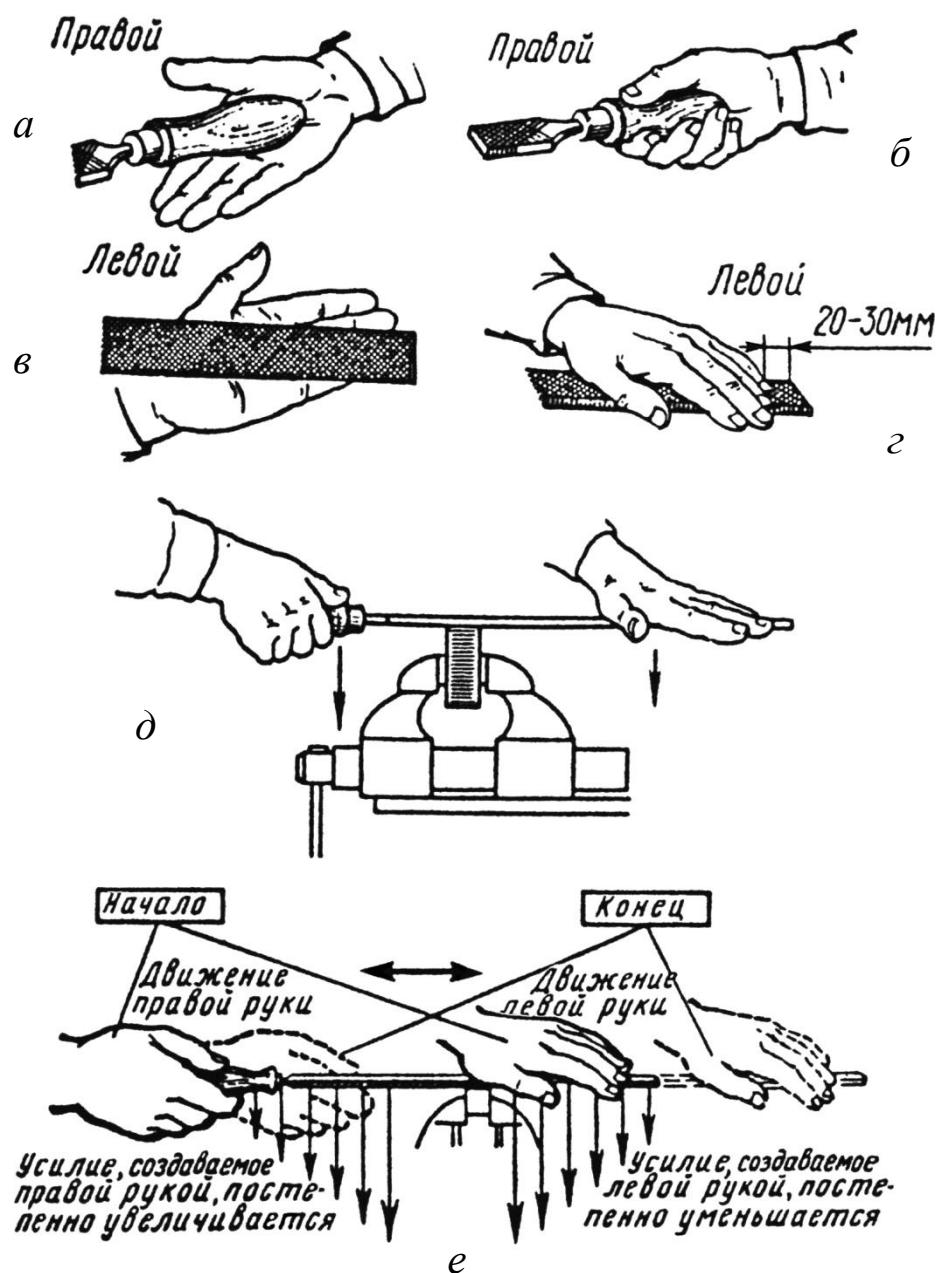
Рисунок 27 – Положение напильника и рабочие движения:
