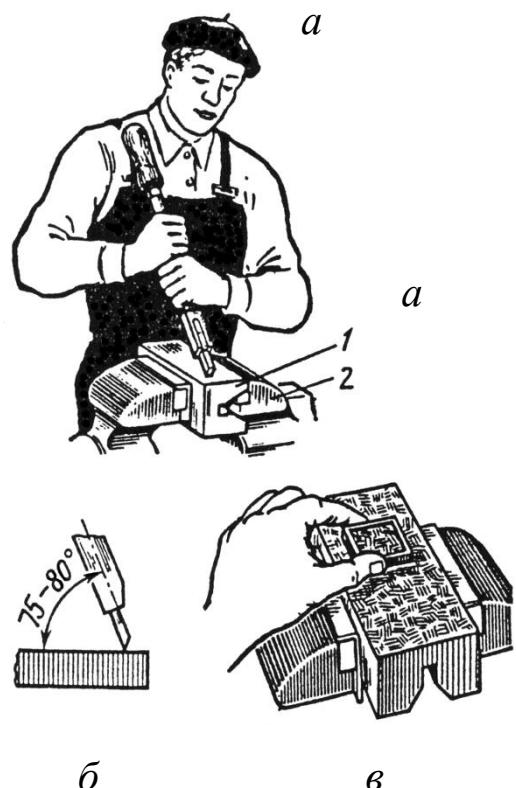
Рисунок 42 – Шабрение способом «на себя»:
