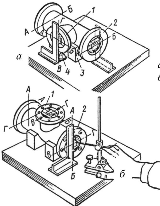
Рисунок 7 – Разметка заготовки с перекантовкой:
