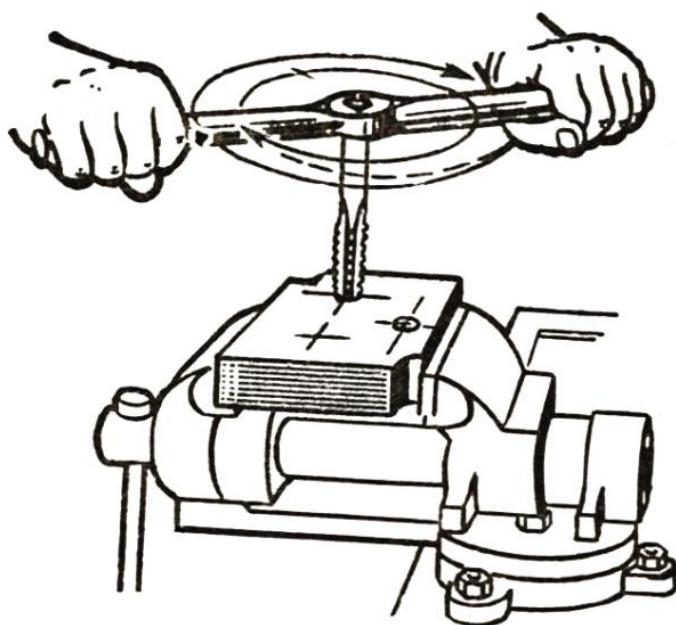
Рисунок 34 – Приёмы нарезания резьбы метчиком
