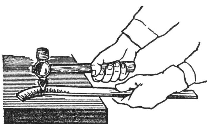
Рисунок 18 – Правка (рихтовка) полосы наклёпом на плите
