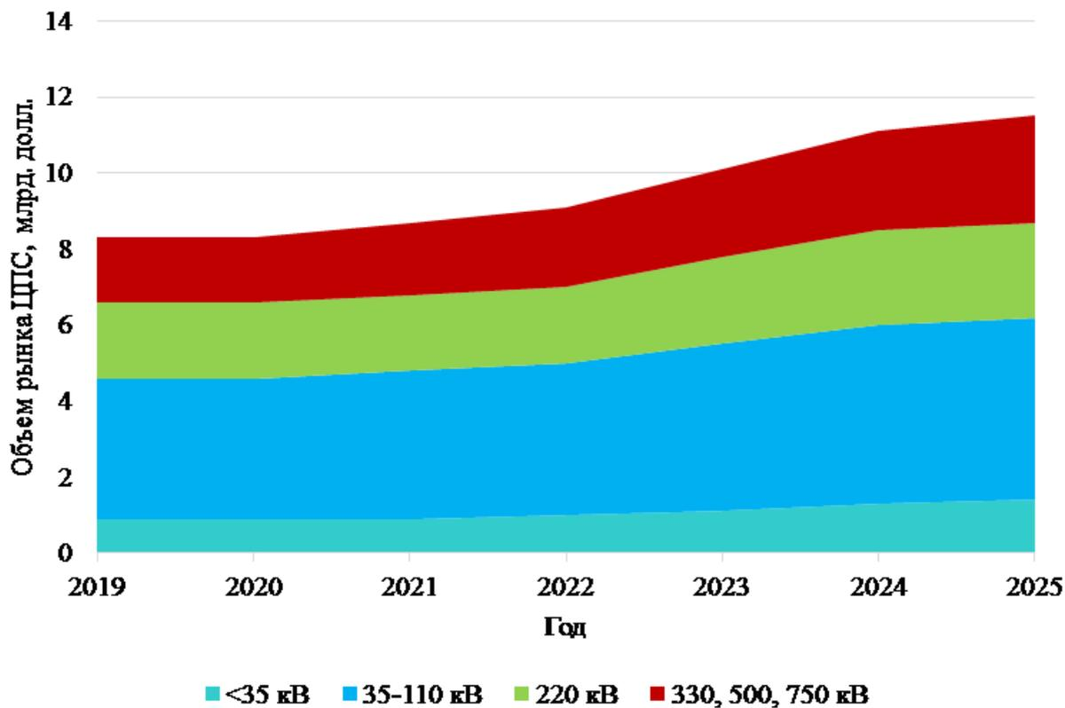
Рис. 9. Классы напряжения объектов под внедрение ПТК ЦПС
