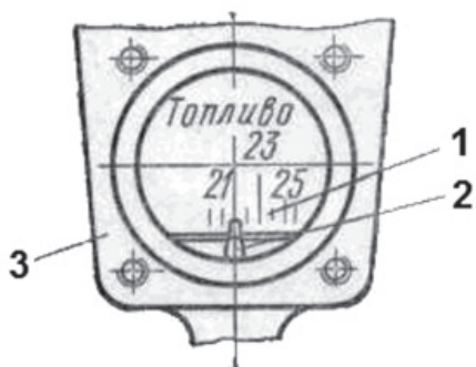
Рисунок 49 – Совмещение рисок на гасителе крутильных колебаний с указанием при регулировке угла опережения впрыска топлива: 1 – гаситель крутильных колебаний; 2 – указатель; 3 – передняя крышка блока
