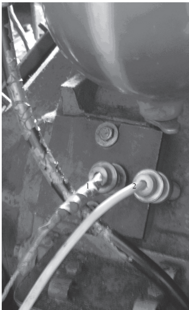
Рисунок 46 – Размещение индуктивных датчиков на двигателе: 1 – индуктивный датчик ВМТ; 2 – индуктивный датчик частоты вращения коленчатого вала
