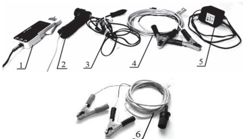
Рисунок 59 – Диагностическое оборудование комплекса: 1 – жгут датчика тока; 2 – стробоскоп; 3 – жгут питания от прикуривателя; 5 – адаптер питания сетевой; 6 – жгут прикуриватель-аккумулятор
