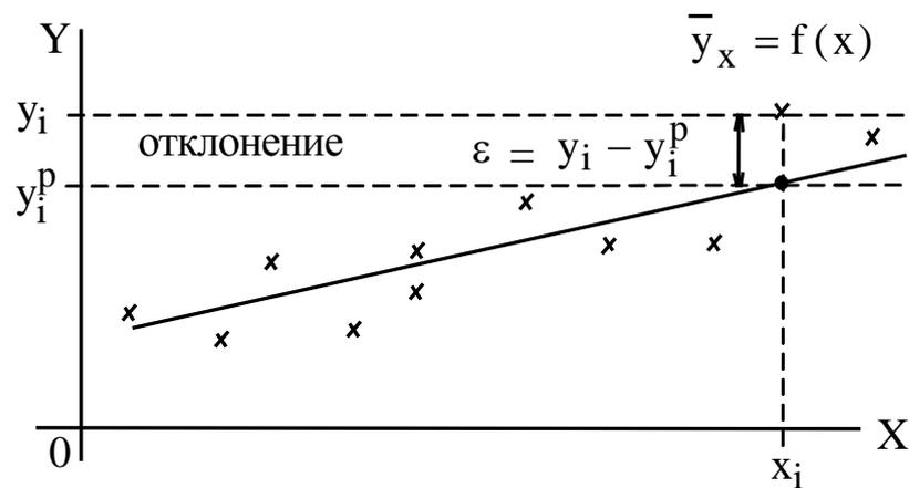
Рисунок 5 - Понятие отклонения  $\varepsilon$  для случая линейной регрессии
