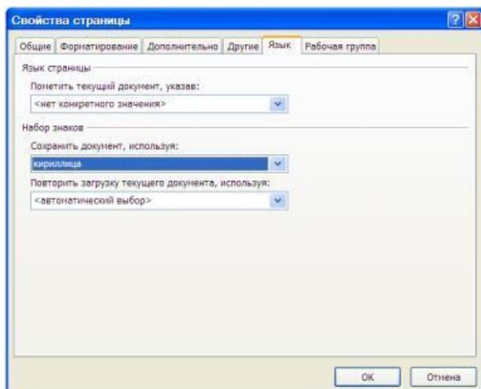
Рисунок 13 - Определение кодировки символов на web-странице
