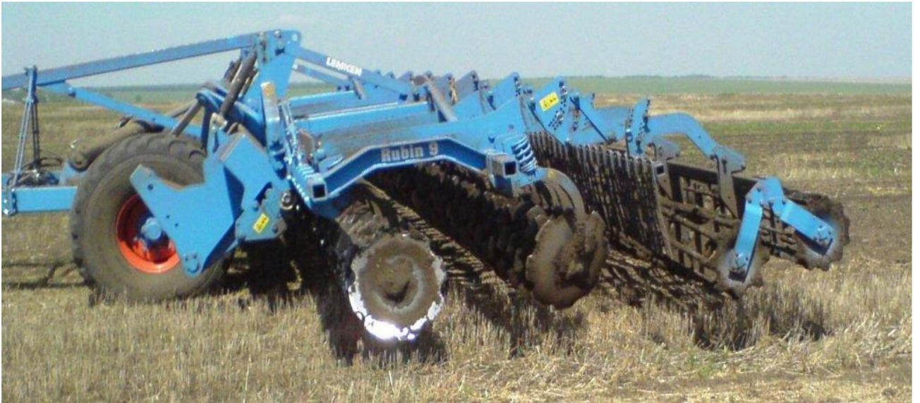
**Рис. 1 - Общий вид дискатора «Gigant 12S/1000 Rubin 9U»**
