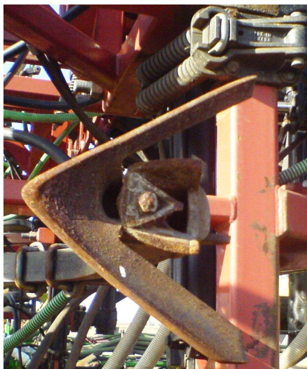
Рис. 5 - Общий вид сошника ППК «Конкорд» (А – в транспортном положении; Б – вид снизу)
