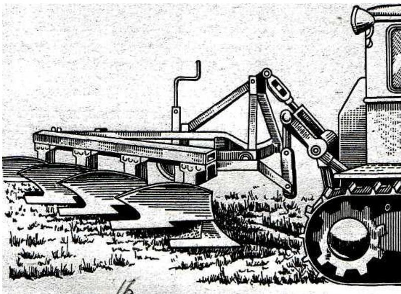
Рис.16. Плуг с вырезными корпусами.
