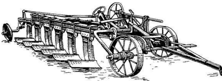
Рис. 11. Плуг конструкции Т.С. Мальцева
