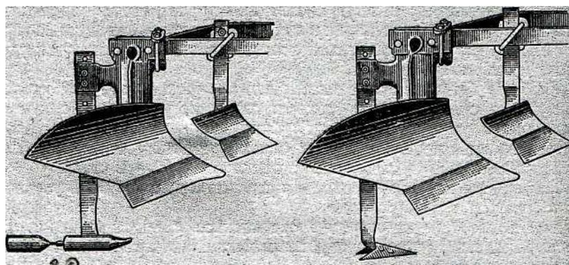
Рис.19. Плуг, оборудованный кротователем (слева) и почвоуглубителем (справа).
