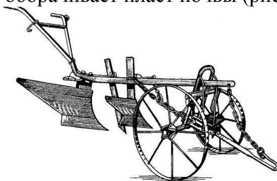
Рис 9. Конный однокорпусный плуг (тип Сакка)
