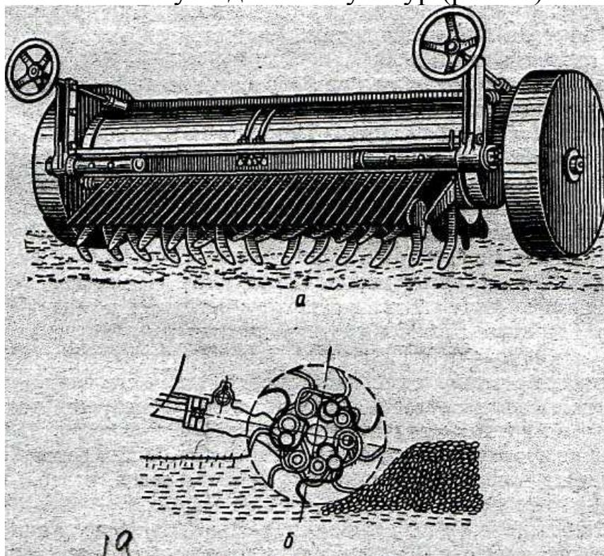
Рис.18. Фреза (а) и схема работы почвенной фрезы (б)
