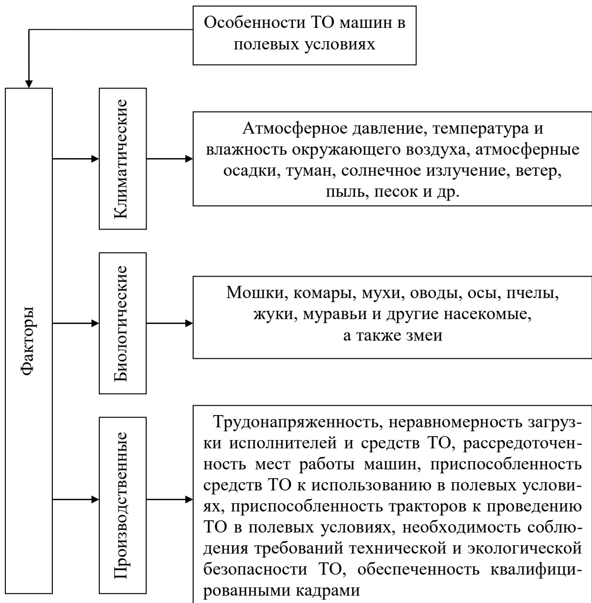
Рисунок 1.4 – Блок-схема формирования факторов, определяющих особенности ТО тракторов в полевых условиях
