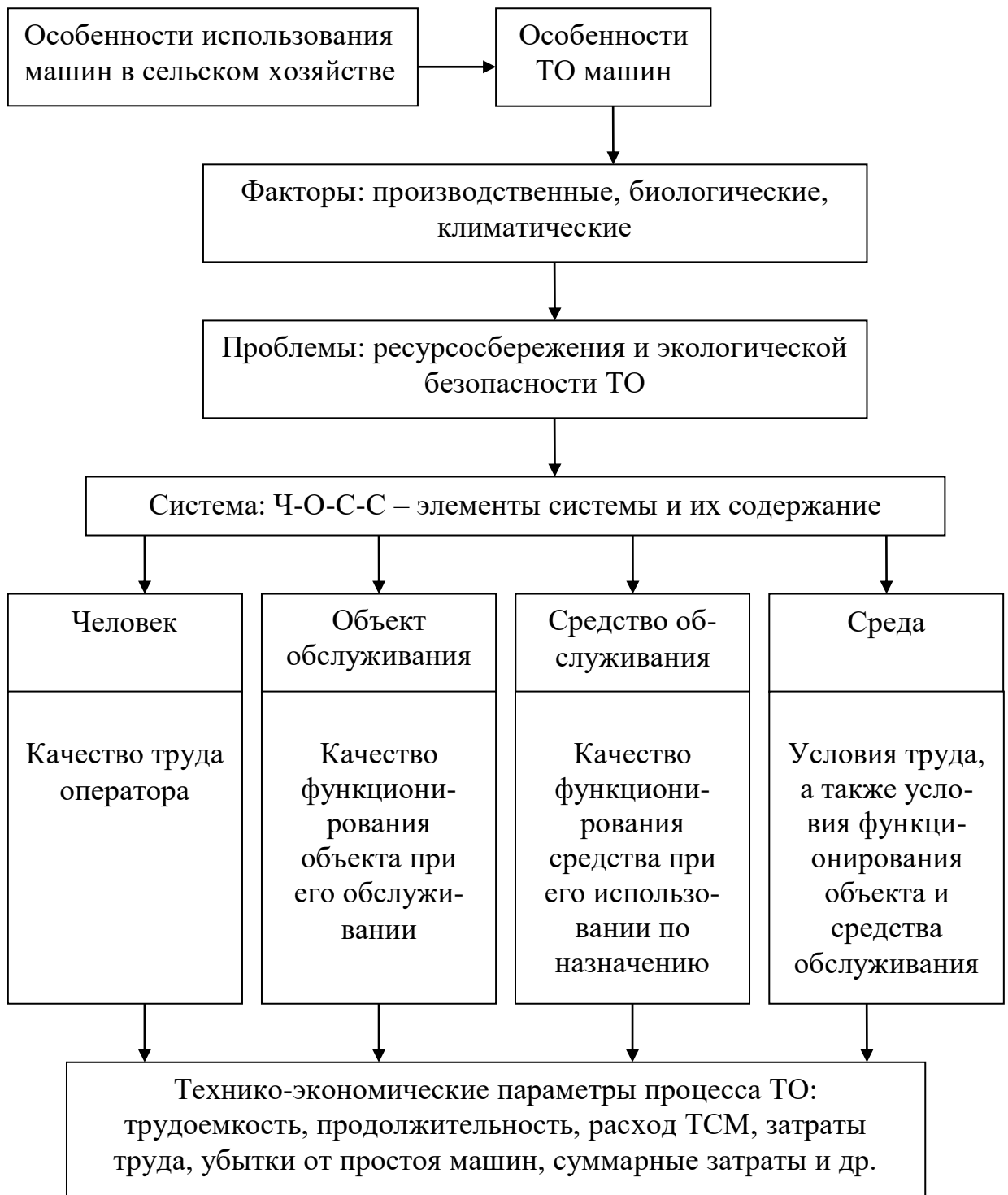
Рисунок 7.1 – Блок-схема формирования проблем ресурсосбережения и экологической безопасности ТО в системе Ч-О-С-С (обозначения – в тексте)
