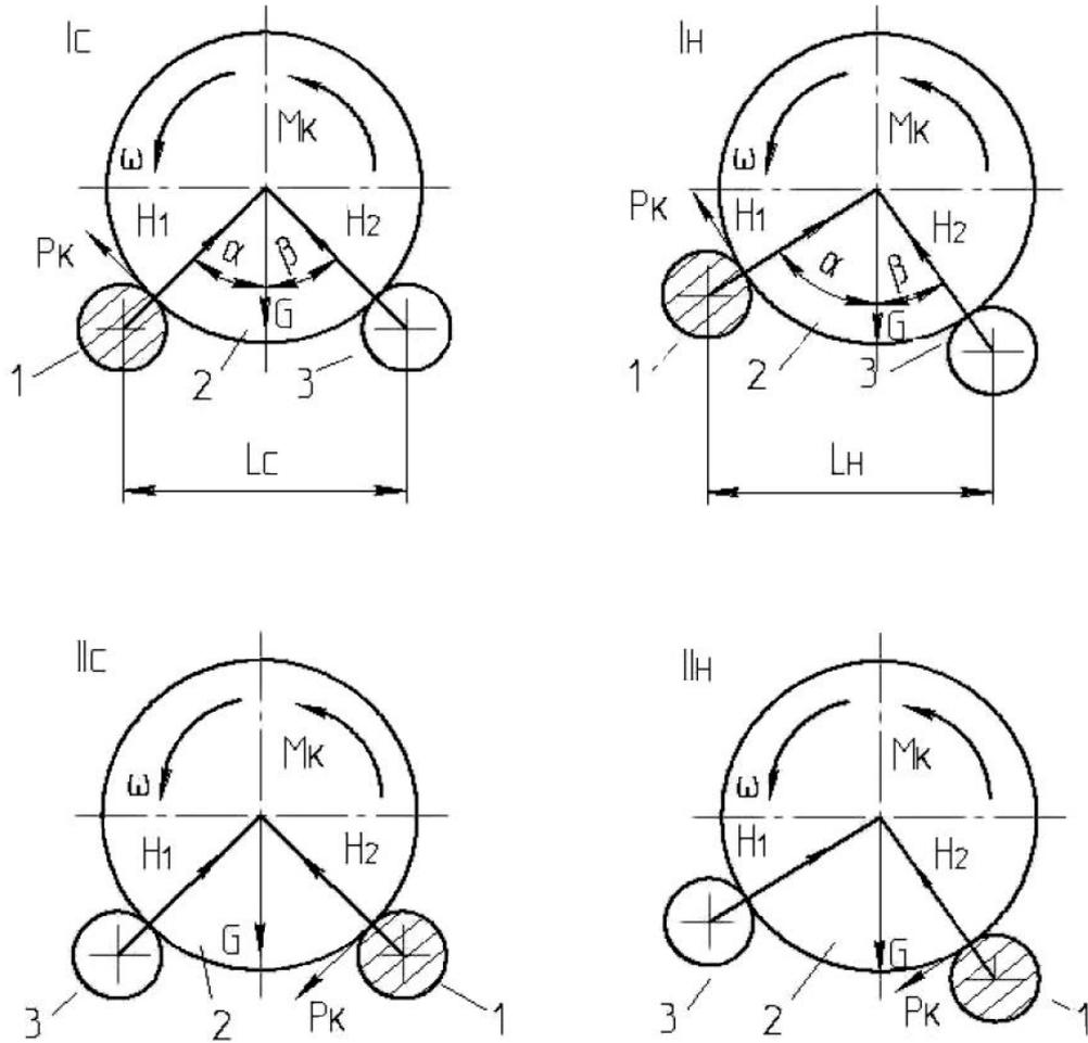
1 – рабочий ролик, 2 – ведущее колесо автомобиля, 3 – свободный ролик;  $I_c$ ,  $II_c$  – симметричное расположение роликов;  $I_n$ ,  $II_n$  – несимметричное расположение роликов;  $M_k$  – крутящий момент на колесе;  $L_c$  и  $L_n$  – межосевые расстояния роликов;  $G$  – вертикальная нагрузка на колесо;  $P_k$  – тяговое усилие на колесе;  $H_1$  и  $H_2$  – реакции на роликах стенда.
