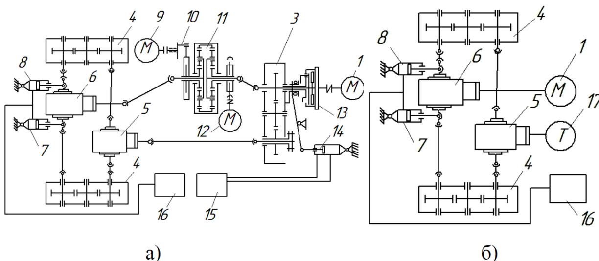
Рисунок 3 – Схема развития стенда с замкнутым контуром мощности
