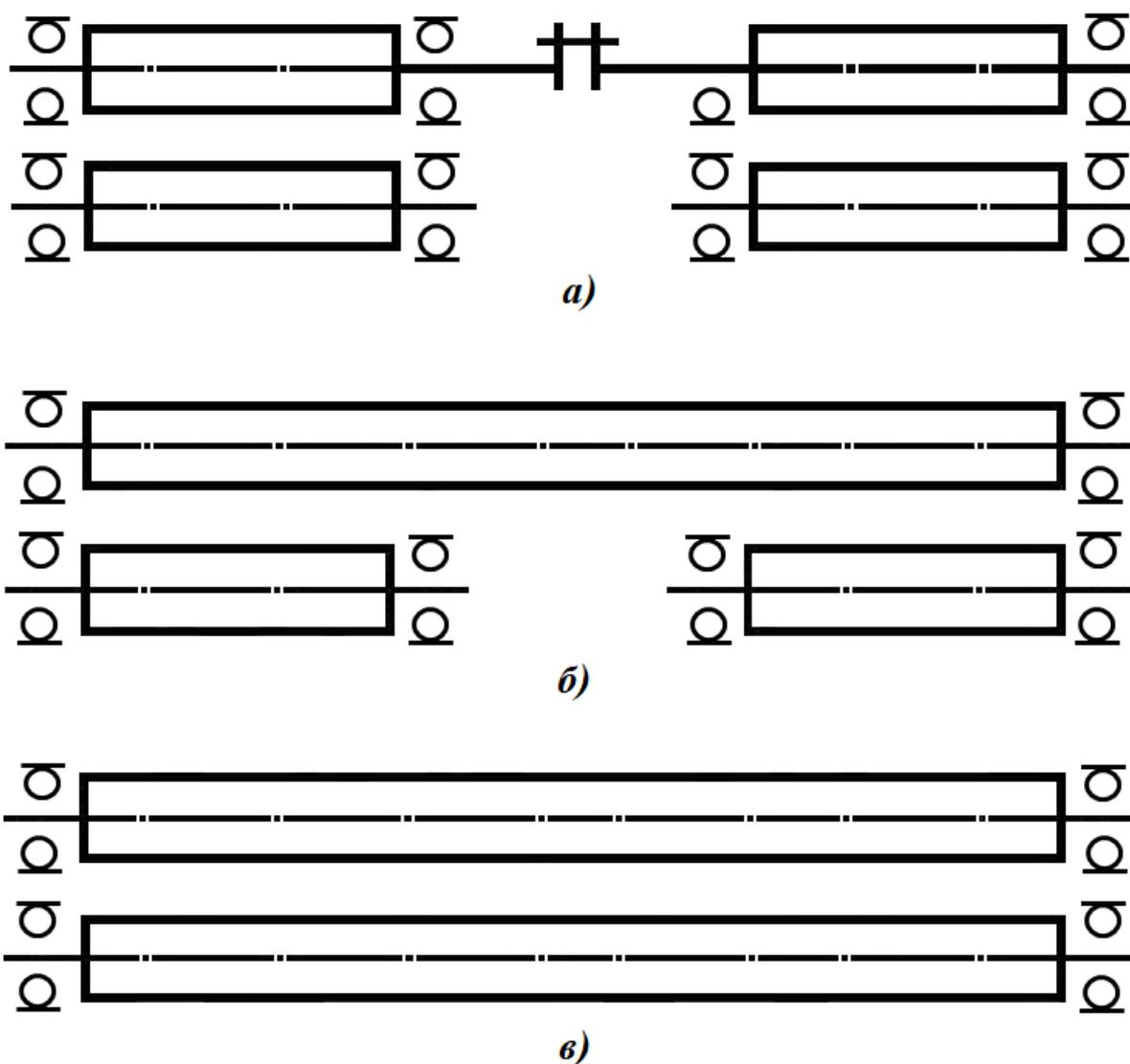
а) отдельные; б) с одним сплошным, в) с двумя сплошными
