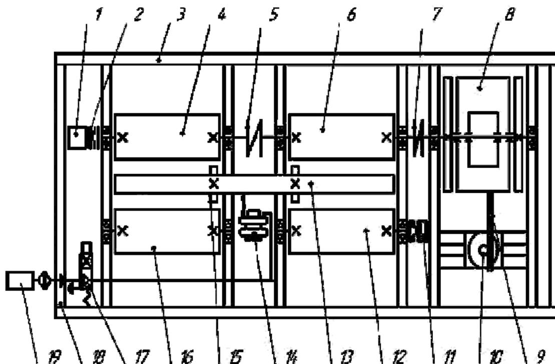
1 – тахогенератор; 2, 5, 7 – муфты; 3 – рама; 4, 6, 12, 16 – ролики; 8 – индуктивный тормоз; 9 – кронштейн; 10 – датчик усилия; 11 – реле скорости; 13 – площадка подъёма машины; 14 – пневмоподъёмник; 15 – тормозной колодочный механизм; 17 – золотник; 18 – поперечина; 19 – узел подготовки воздуха.
