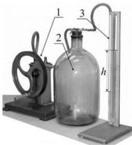
Рисунок 1 – экспериментальная установка Клемана-Дезорма. 1 – насос, 2 – баллон с воздухом, 3 – манометра
