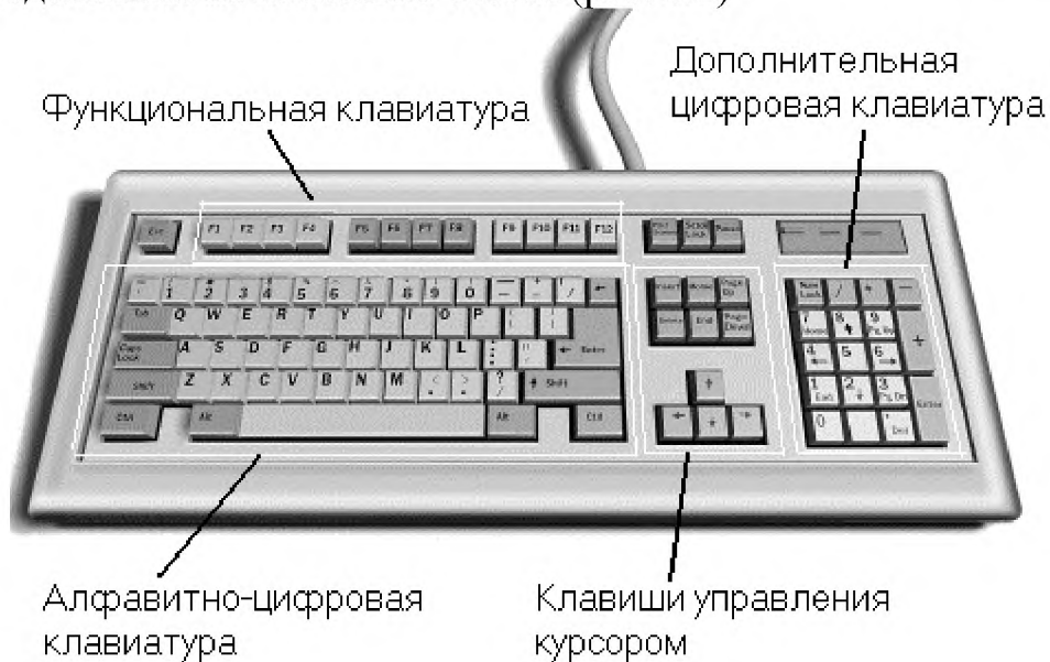
Рис. 3.2. Структура стандартной клавиатуры
