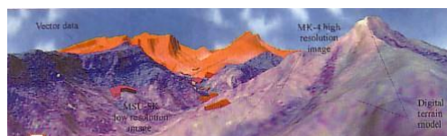
Рисунок 4.2.3. – 3D-модель, построенная с использованием топоосновы и космических снимков
