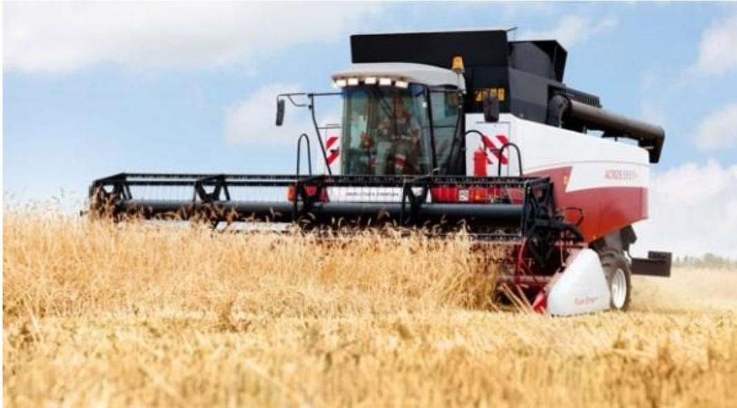
Der Mähdrescher stellt eine Kombination von Mäh- und Dreschmaschine dar. In einem Arbeitsgang bewältigt er gleichzeitig das Ernte und Aufbereiten von Halm- und Ölfrüchten. Zur Erntezeit sind die Mähdrescher ohne Zweifel ausschlaggebend.
