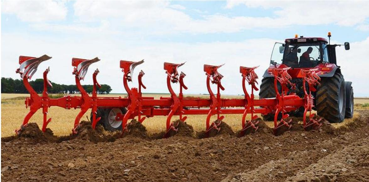
Die Maschinen pflügen, lockern, düngen den Boden. Zur Bearbeitung des Bodens stehen der Landwirtschaft folgende Geräte zur Verfügung: zum Lockern mit der Wendung der Schicht – der Pflug; zum Lockern, zur Ebnung des Oberflächenfeldes und zur Vernichtung des Unkrautes – die Egge, der Grubber, die Schleppe; zum Verdichten – die Walze.
