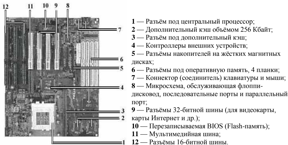
Рис. 2.9. Системная плата компьютера класса Pentium
