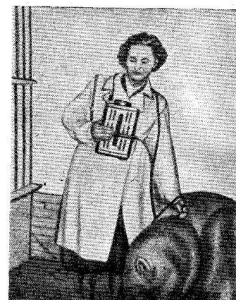
Рис. 27. Оператор определяет толщину сала и мышц с помощью ультразвукового прибора.
