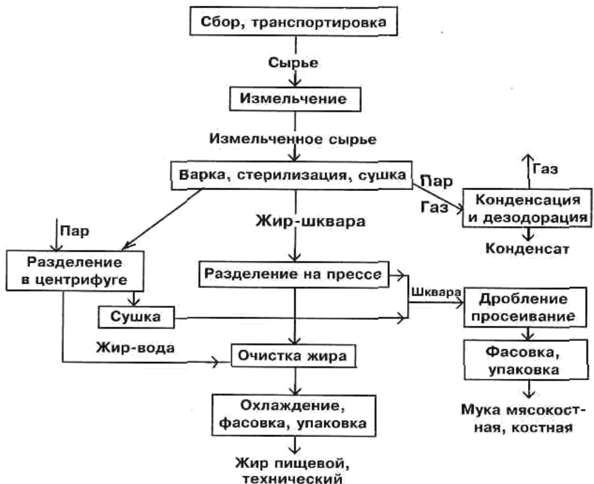
Рис. 9. Схема технологии переработки жиросодержащего сырья (мягкого и твердого) сухим способом
