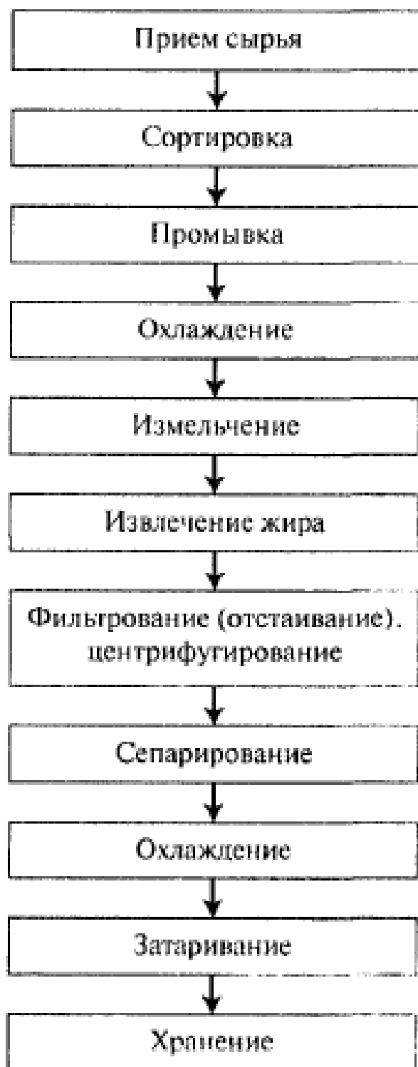
Рис. 3.10. Технологическая схема получения топленых жиров
