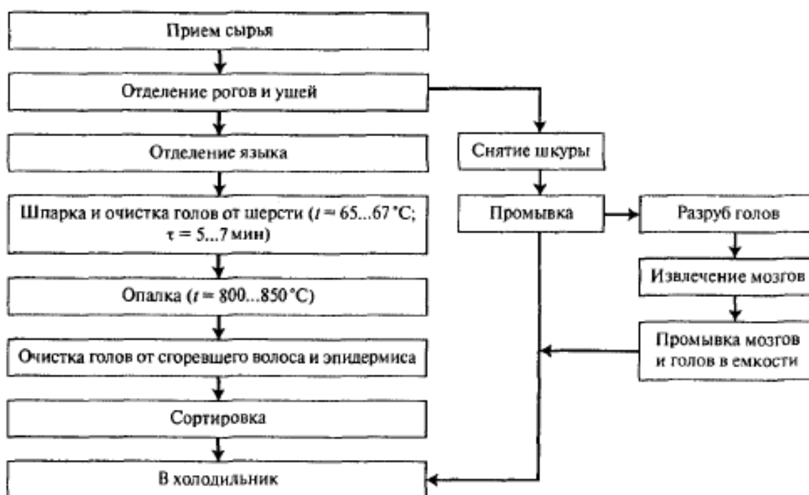
Рис. 3.5. Технологическая схема обработки голов мелкого рогатого скота
