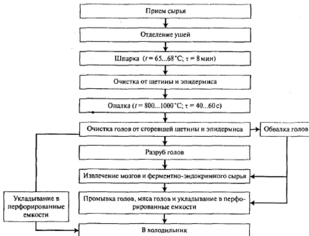
Рис. 3.4. Технологическая схема обработки свиных голов
