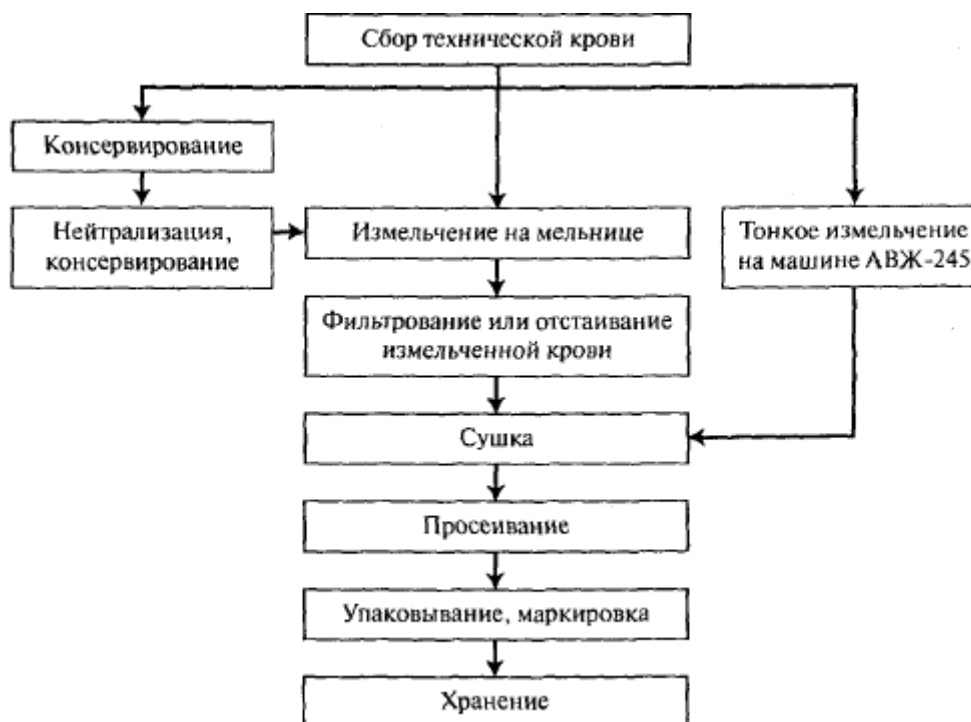
Рис. 3.14. Технологическая схема получения черного технического альбумина
