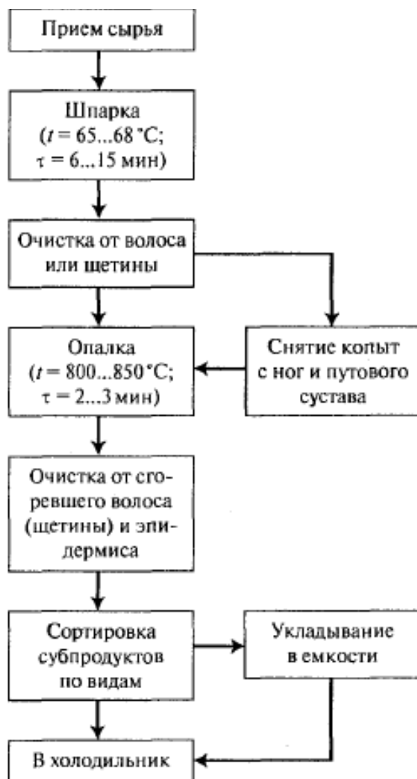
Рис. 3.7. Технологическая схема обработки шерстных субпродуктов
